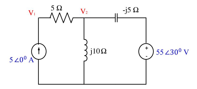
$$5 \angle 0^0 + \frac{55 \angle 30^0 - V_2}{-j5} = \frac{V_2}{j10}$$
