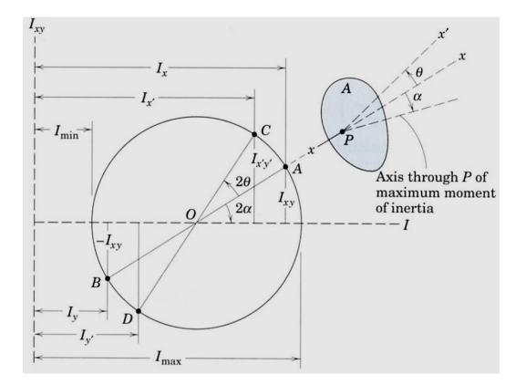
$$\tan 2\alpha = \frac{2I_{xy}}{I_y - I_x} \qquad I_{x'} = \frac{I_x + I_y}{2} + \frac{I_x - I_y}{2} \cos 2\theta - I_{xy} \sin 2\theta$$
